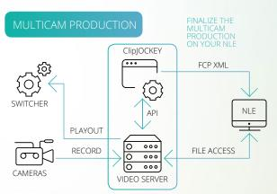
CONTROL UP TO 16 PORTS FRAME SYNCHRONOUSLY FOR RECORD AND PLAYOUT
